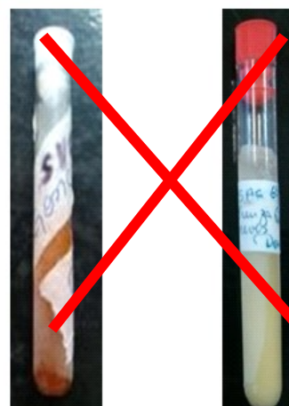
Figura 6: Forma inadequada de etiquetagem dos tubos (não colocar etiqueta enrolada nos tubos)
